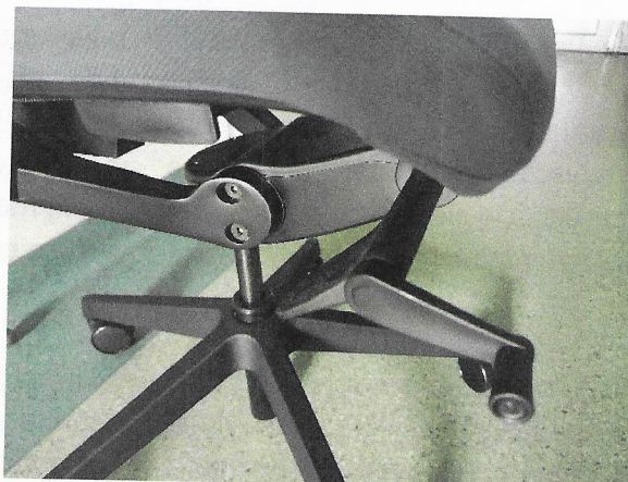
Manualna regulacja wstępnego napięcia sprężyn w zależności od masy ciała użytkownika
